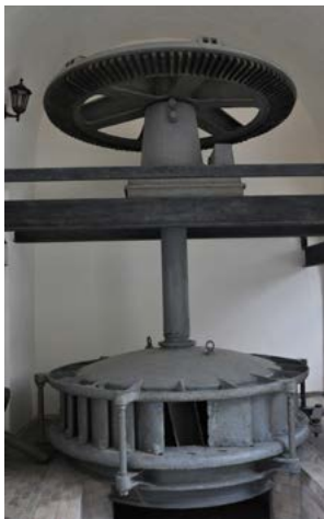
▲ Turbína vyrobená v blanianských železiarňach na prelome 19. a 20. storočia. Slúžila vo vodárni v Pisárkách (Brno). Vyraďená 1967.
